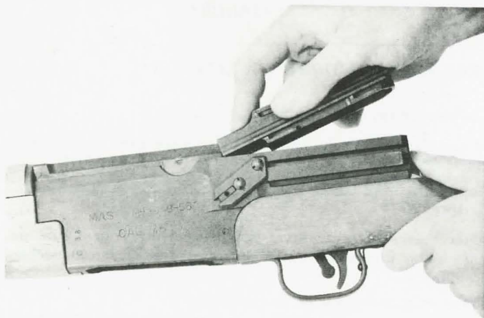
Fig. 13. — Démontage du couvre-culasse
