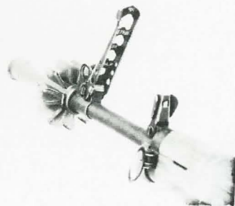
Fig. 10. — Tir tendu de grenade à fusil avec grille de visée à 74°
