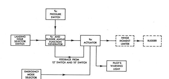
FIG. 20 Qc ACTUATOR SYSTEM - BLOCK DIAGRAM
