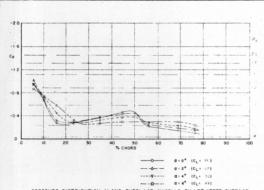
PRESSURE DISTRIBUTION ALONG FUSELAGE-NACELLE FILLET-UPPER SURFACE
