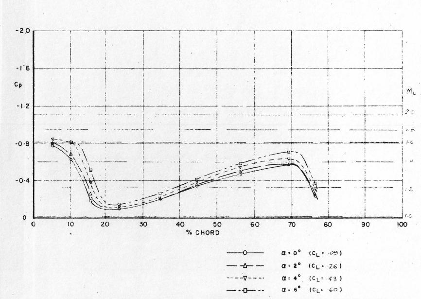
PRESSURE DISTRIBUTION ALONG FUSELAGE-NACELLE FILLET-UPPER SURFACE
