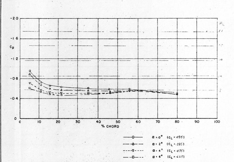
PRESSURE DISTRIBUTION ALONG FUSELAGE-NACELLE FILLET-LOWER SURFACE
