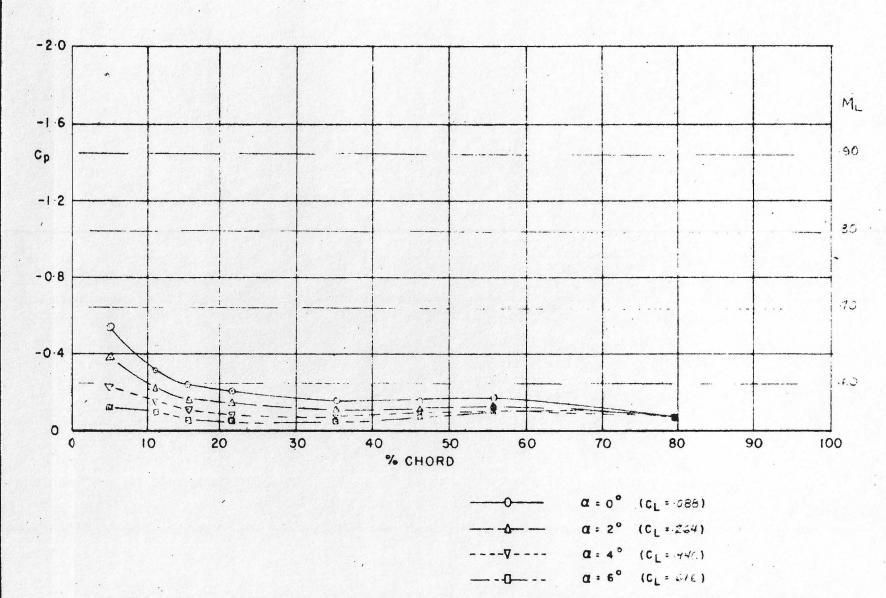
PRESSURE DISTRIBUTION ALONG FUSELAGE-NACELLE FILLET-LOWER SURFACE
