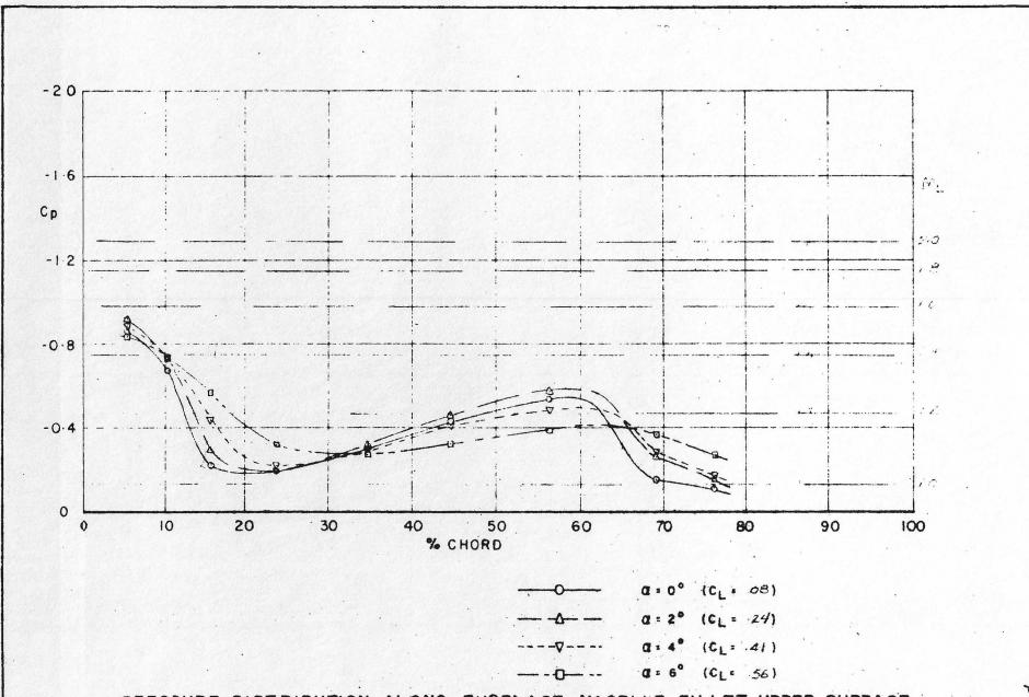
PRESSURE DISTRIBUTION ALONG FUSELAGE-NACELLE FILLET-UPPER SURFACE
