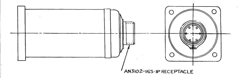
POWER FAILURE DETECTOR
