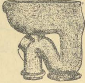
(شكل ٧١) الأنبوبة الملتوية التي يبقى فيها الماء فيمنع انتشار الرائحة الكريهة
