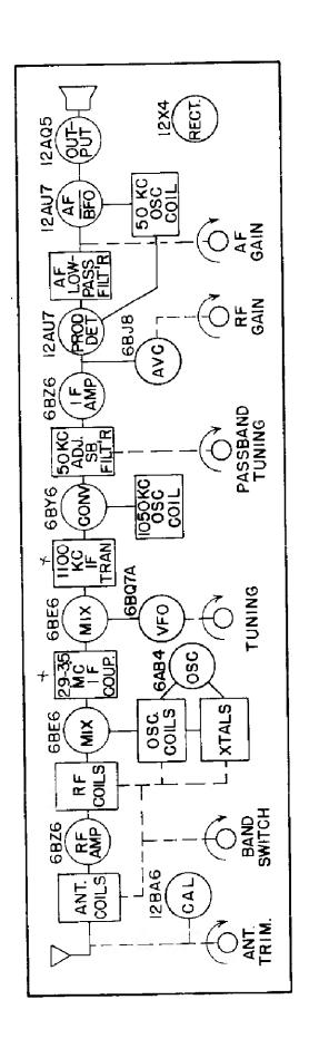
BLOCK DIAGRAM -- MODEL I-A SIDEBAND RECEIVER
