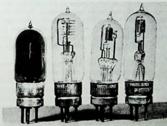
Fig. 19-20. Triode Junot Detecteurs and Amplificateurs.
