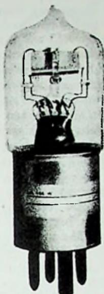
Fig. 21-37. Radioröhrenfabrik MS-30 tube.
