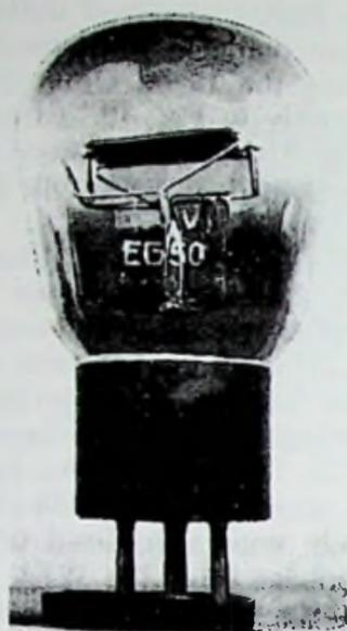
Fig. 22-10. Ostar EG50 110-volt rectifier tube.
