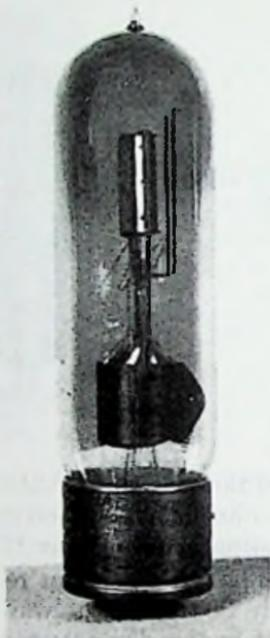
Fig. 16-21. Radiotron
