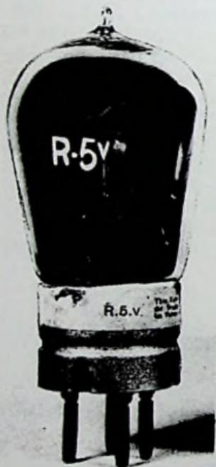
Fig. 18-25. Marconi-Osram R5V valve.
