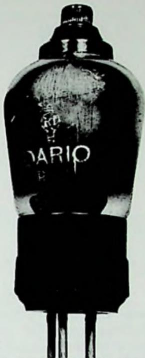
Fig. 19-14. Dario R89 pentode output tube.
