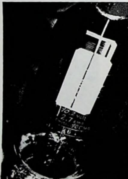
Fig. 21-38. Markings on Radioröhrenfabrik MS-30.
