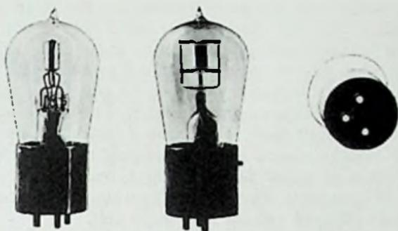
Fig. 8-16. Kenotron TB1 tube.
