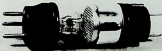
Fig. 18-27. Marconi-Osram S625 valve.
