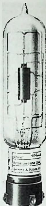
Fig. 21-7. Siemens & Halske BE tube.
