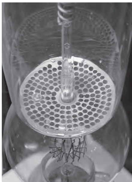
Fig. 4. Lieben Valve detail.
