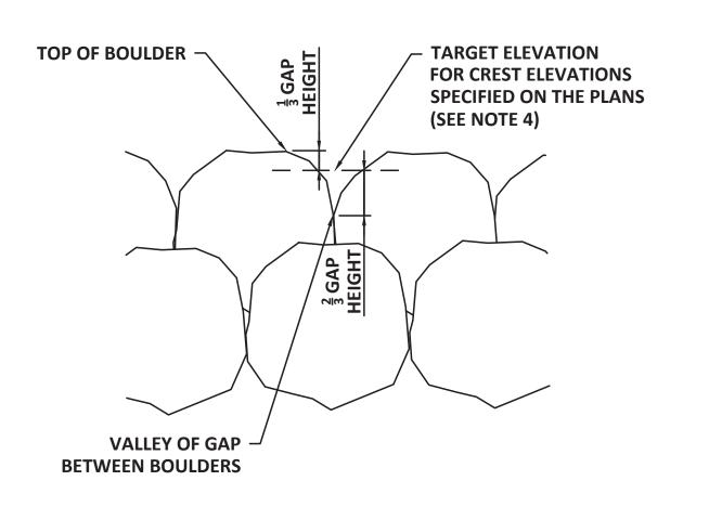
WEIR CREST-ELEVATION DETAIL
